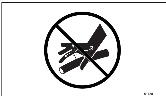
Figur 205 Brug ALDRIG fingre eller hænder ved søgning efter utætheder.
