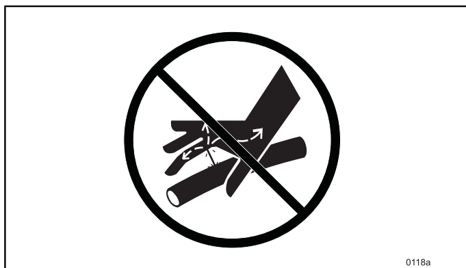
Figur 224 Brug ALDRIG fingre eller hænder ved søgning efter utætheder.
