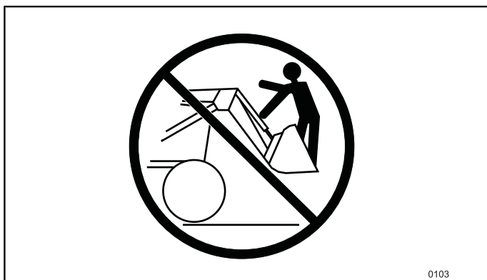
Abbildung 72 Verwenden Sie den Lader oder das Gerät NICHT zum Heben oder Transport von Personen.
