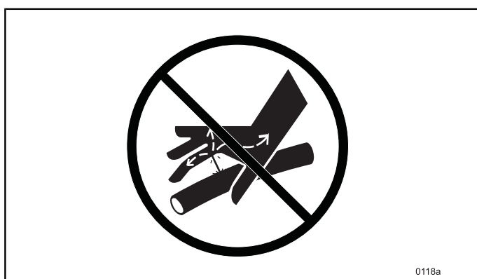
Rys. 173 NIGDY nie szukaj wycieków palcami lub dłońmi.
