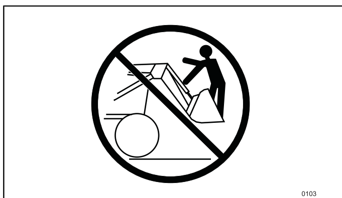
Fig.104 Le chargeur ne doit PAS être utilisé pour soulever ou transporter des personnes.
