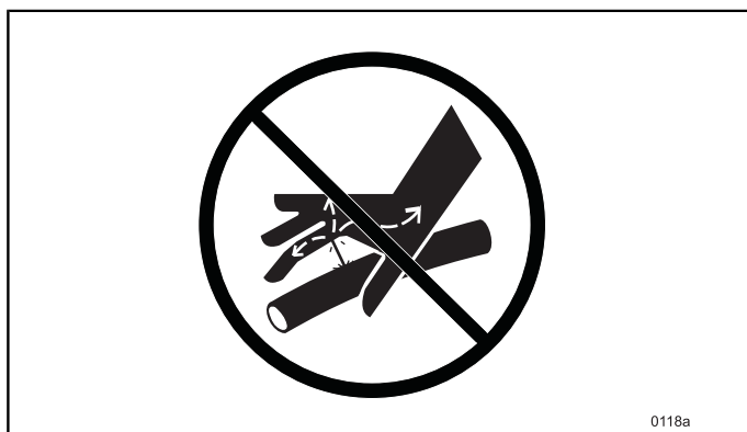
Figura 267 Non cercare MAI le perdite servendosi delle dita o delle mani nude.
