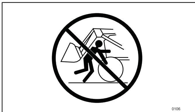
Figura 126 No se coloque nunca entre la frontal del tractor y el tubo transversal de la pala.
