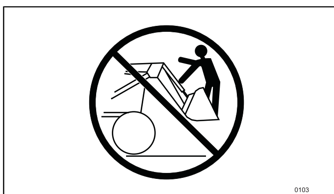
Fig.94 Le chargeur ne doit PAS être utilisé pour soulever ou transporter des personnes.
