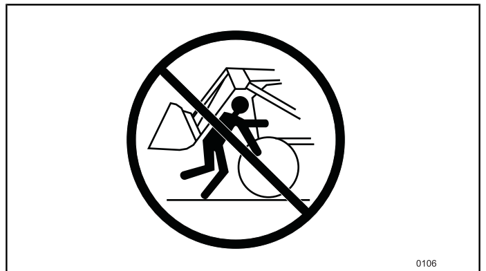
Fig.98 Ne vous tenez jamais entre l'avant du tracteur et le tube transversal du chargeur.
