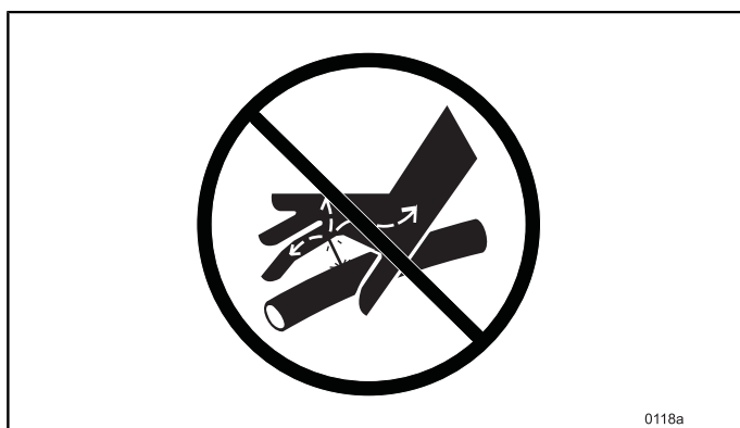
Figur 168 Brug ALDRIG fingre eller hænder ved søgning efter utætheder.
