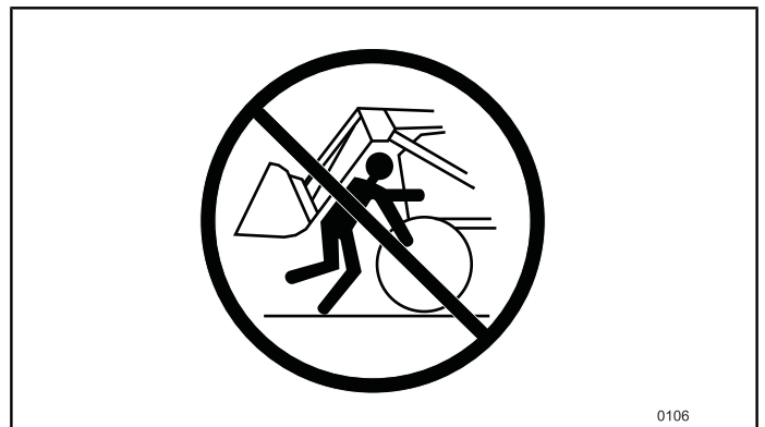
Abbildung 70 Unter einem angehobenen Lader NIE stehen, gehen oder arbeiten.
