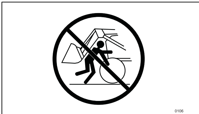
Figur 38 Stå aldrig mellan traktorns front och lastarens tvärrör.
