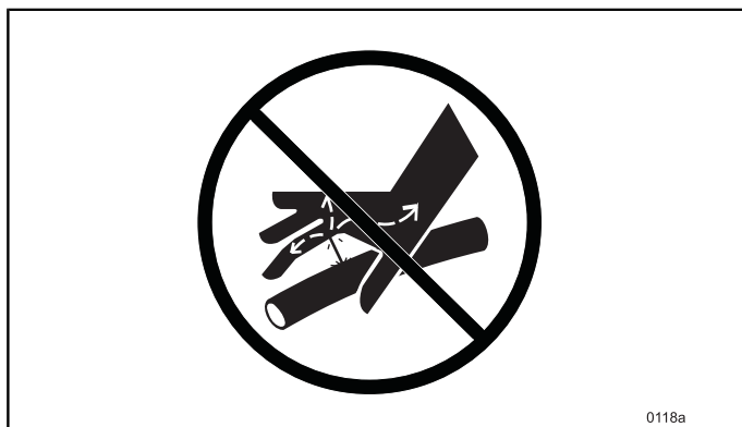
Figur 169 Brug ALDRIG fingre eller hænder ved søgning efter utætheder.
