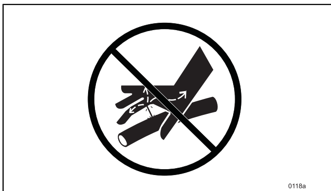
Fig.91 N'utilisez JAMAIS les doigts ou la main pour rechercher une fuite.
