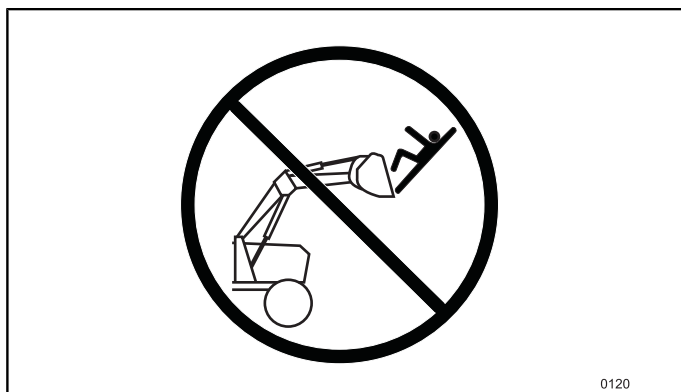
Fig.85 Il ne faut PAS utiliser le chargeur ou l'outil comme plate-forme de travail.
