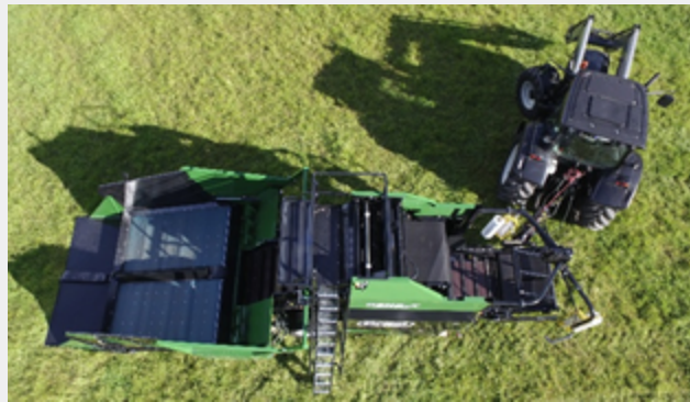
Figur 4.1 : Innretting av traktor. Påse at traktoren er på samme linje som kraftuttakets drivaksel.
