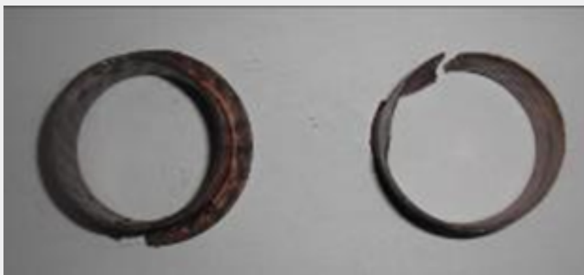
Figur 7.32 : Eksempelbilde for enkelt lager. Nytt lager til venstre og utslitt/defekt lager til høyre.
