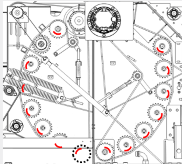
Figur 7.28 : Sjekk om det er slark i bøssingene. Røde merker angir områder på bøssingene.
