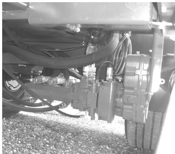
Inngående aksel gearboks - hydraulikkpumpe
