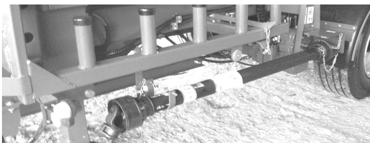
Kraftoverføringsaksling i transportstilling
