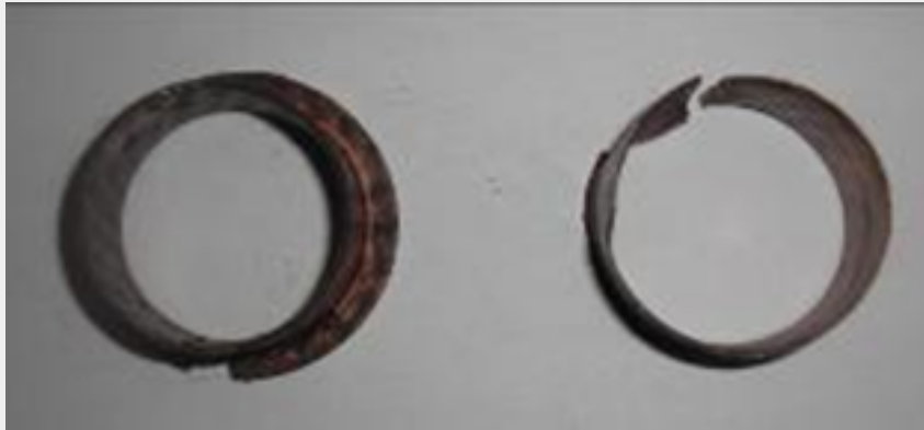
Figur 7.30 : Eksempelbilde for enkelt lager. Nytt lager til venstre og utslitt/defekt lager til høyre.
