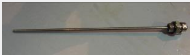
Figur 7.32 : Peilepinne med maks.- og min.-indikatorer
