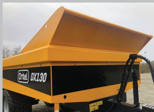
Frontskjerm som standardutstyr hindrer spill framover
