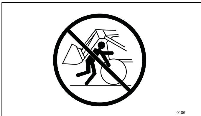
Obr.303 Nikdy nestůjte mezi přední stranou traktoru a příčnými trubkami nakladače.
