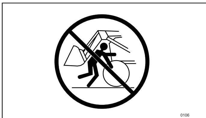
Abbildung 78 Vorsichtig kontrollieren, dass keine Kollisionsgefahr zwischen Lader und Gerät besteht.
