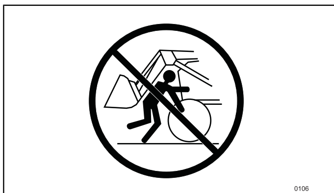
Fig.100 Ne vous tenez jamais entre l'avant du tracteur et le tube transversal du chargeur.
