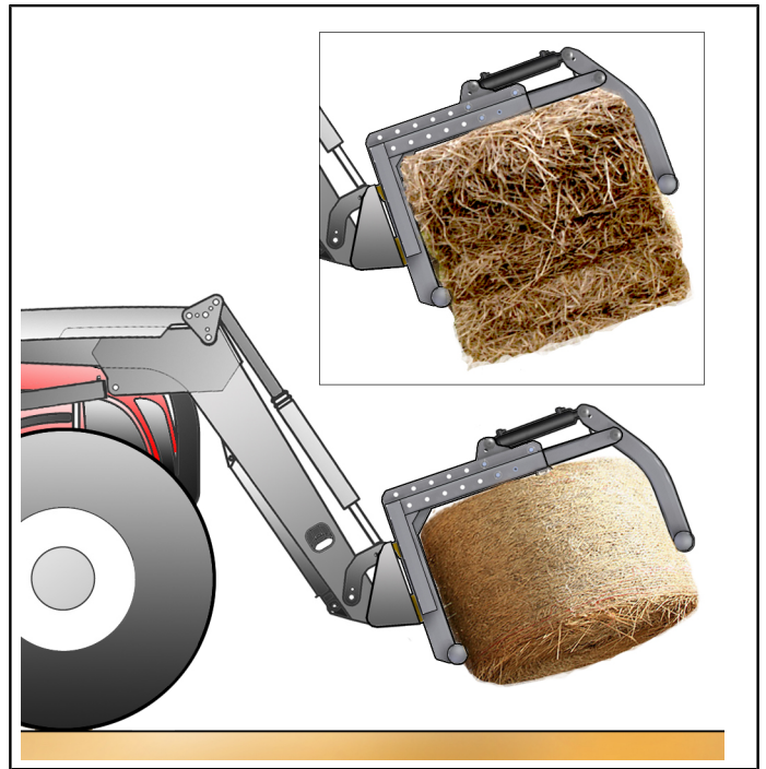
Kuva 199 Kuljeta materiaalia niin matalalla kuin mahdollista.
