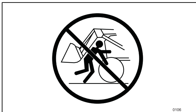
Figur 172 Stå aldrig mellem traktorens front og læsserens tværrør.
