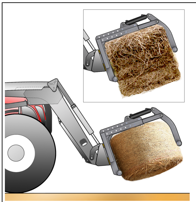
Abbildung 83 Transportieren Sie das Material so niedrig wie möglich.
