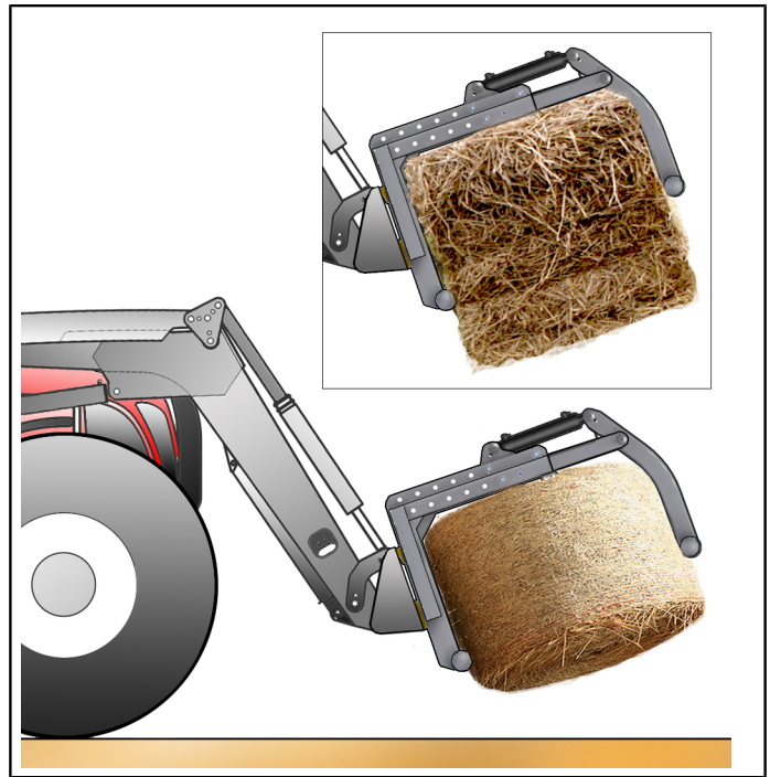
Rys. 141 Materiał należy transportować na możliwie jak najmniejszej wysokości
