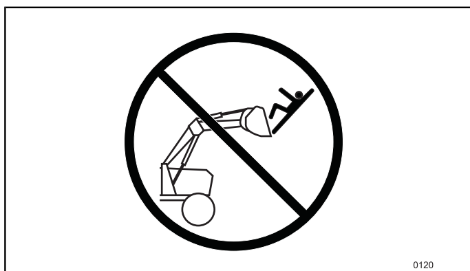
Kuva 181 ÄLÄ käytä kuormainta tai työvälinettä työtasona.
