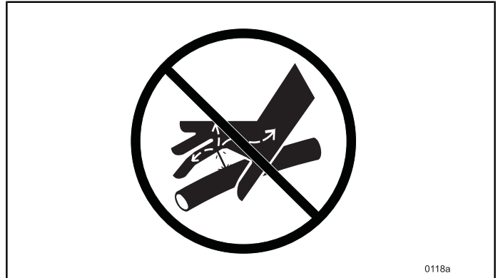
Abbildung 72 Verwenden Sie bei der Lecksuche UNTER KEINEN UMSTÄNDEN Finger oder Hände.
