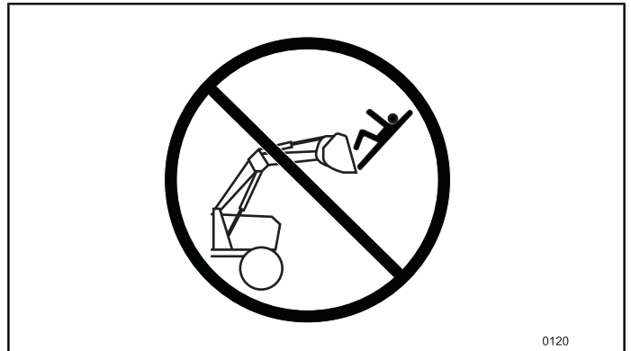
Fig.94 Il ne faut PAS utiliser le chargeur ou l'outil comme plate-forme de travail.
