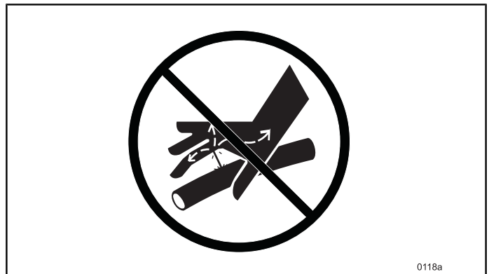
Figur 159 Brug ALDRIG fingre eller hænder ved søgning efter utætheder.
