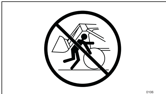
Rys. 143 Nigdy nie stawaj między przodem traktora a rurą poprzeczną ładowarki.
