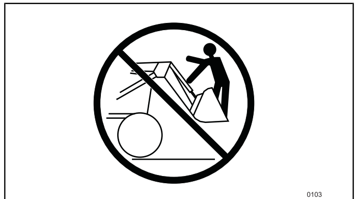
Fig.95 Le chargeur ne doit PAS être utilisé pour soulever ou transporter des personnes.
