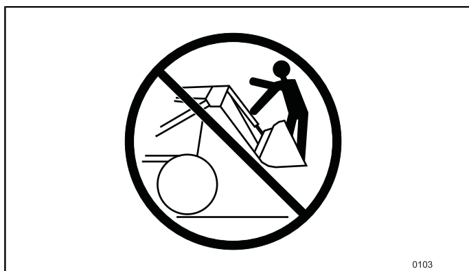
Rys. 124 NIE używaj ładowarki lub osprzętu do podnoszenia lub przewożenia osób.
