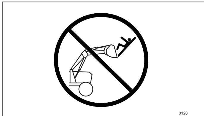
Obr.297 Nakladač nebo náradí NEPOUŽÍVEJTE jako pracovní plošinu.
