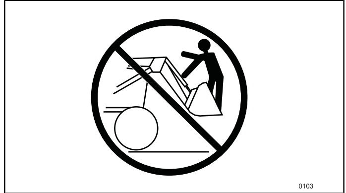
Kuva 182 ÄLÄ käytä kuormainta tai työvälinettä henkilöiden nostamiseen tai kuljettamiseen.
