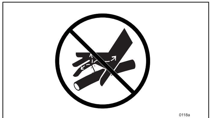
Abbildung 87 Verwenden Sie bei der Lecksuche UNTER KEINEN UMSTÄNDEN Finger oder Hände.
