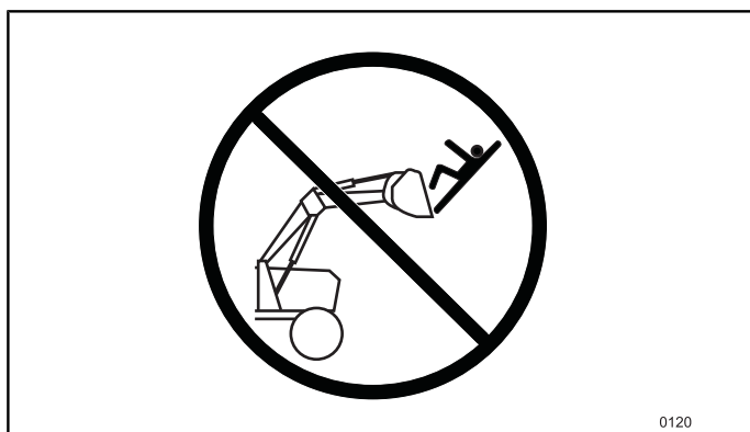
Rys. 123 NIE używaj ładowarki lub osprzętu jako platformy roboczej.
