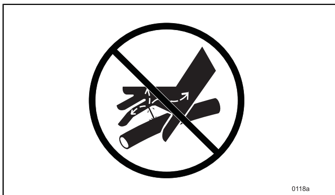
Rys. 130 NIGDY nie szukaj wycieków palcami lub dłońmi.
