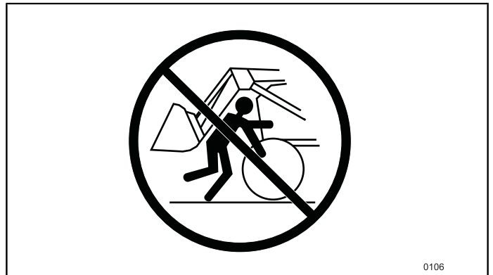
Kuva 194 Tarkista huolellisesti, ettei kuormaimen ja työlaitteen välillä ole törmäysvaaraa.
