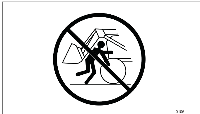
Kuva 201 Älä seiso koskaan traktorin etuosan ja kuormaimen poikkiputken välissä.
