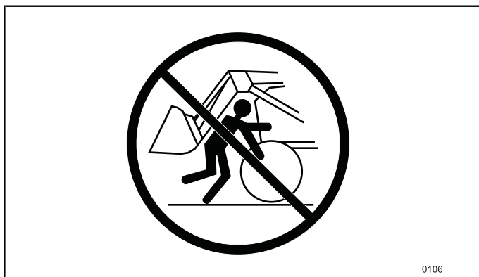
Abbildung 71 Stehen Sie nie zwischen der Front des Traktors und dem Querträger des Laders.
