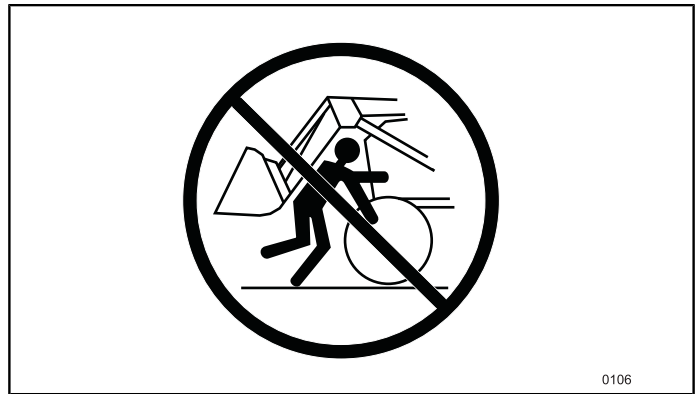
Figura 274 Non mettersi mai fra la parte anteriore del trattore e la traversa del caricatore.
