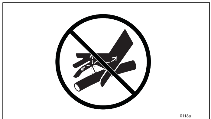
Fig.116 N'utilisez JAMAIS les doigts ou la main pour rechercher une fuite.
