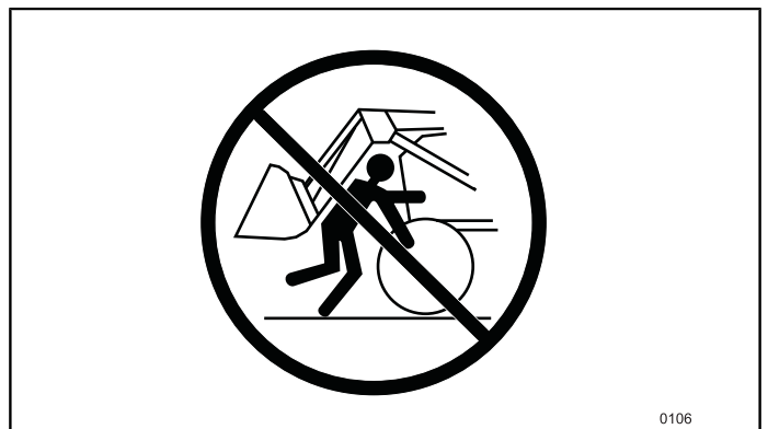
Rys. 136 Sprawdź dokładnie, że nie istnieje ryzyko zderzenia ładowacza i wdrożenia.
