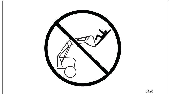
Afbeelding 239 Gebruik de voorlader of het werktuig NIET als werkplatform.
