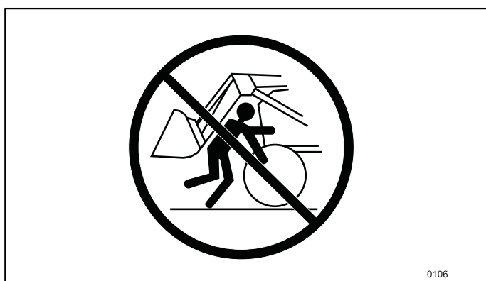
Afbeelding 252 Controleer voorzichtig en zie erop toe dat er geen botsing tussen voorlader en werktuig kan plaatsvinden.
