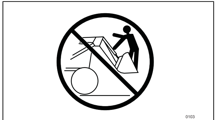
Afbeelding 240 Gebruik de voorlader of het werktuig NIET om personen op te tillen of te vervoeren.
