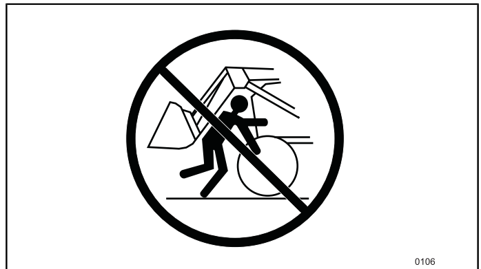
Figur 158 Stå aldrig mellem traktorens front og læsserens tværrør.
