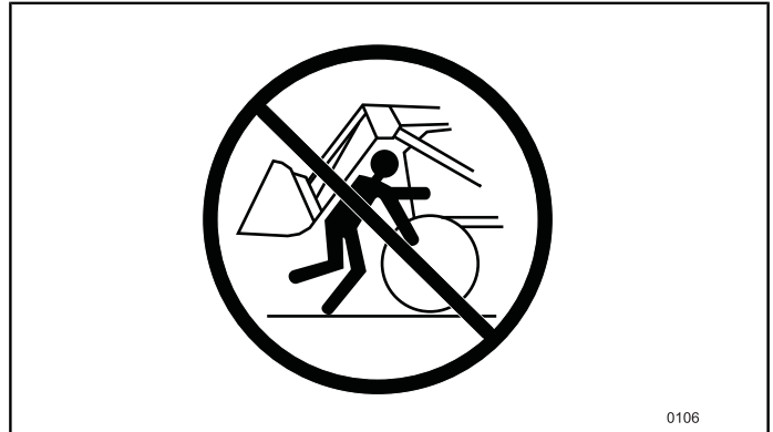
Afbeelding 259 Ga nooit tussen de voorkant van de tractor en de dwarsbuizen van de voorlader staan.
