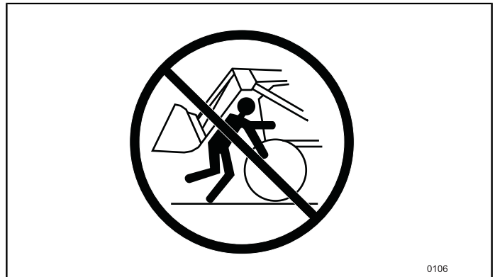
Figur 216 Stå aldri mellom traktorens front og lasterens tverrør.
