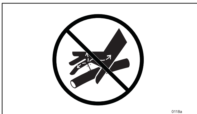
Figur 174 Brug ALDRIG fingre eller hænder ved søgning efter utætheder.
