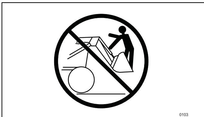
Figur 37 Använd INTE lastaren eller redskapet till att lyfta eller transportera personer.
