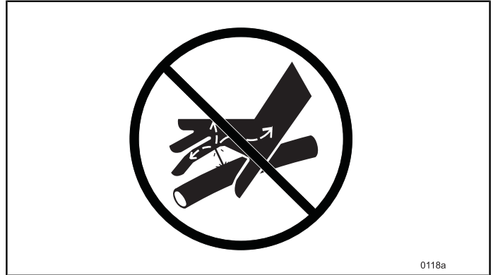
Fig.101 N'utilisez JAMAIS les doigts ou la main pour rechercher une fuite.
