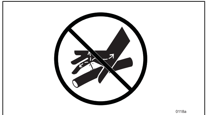
Afbeelding 246 Tijdens het opsporen van lekkage NOOIT uw vingers of handen gebruiken.
