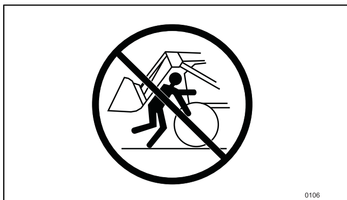
Figur 223 Kontroller at det ikke foreligger kollisjonsfare mellom laster og redskap.
