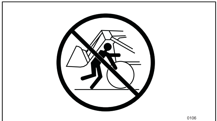
Figur 42 Stå aldrig mellan traktorns front och lastarens tvärrör.
