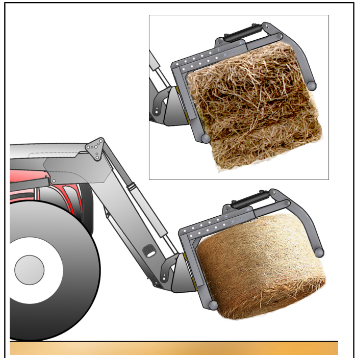
Obr.315 Materiál přepravujte co nejnižší
