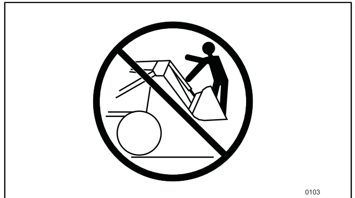
Abbildung 66 Verwenden Sie den Lader oder das Gerät NICHT zum Heben oder Transport von Personen.
