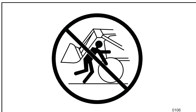
Kuva 187 Älä seiso koskaan traktorin etuosan ja kuormaimen poikkiputken välissä.
