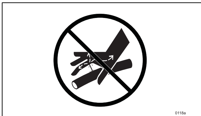
Rys. 145 NIGDY nie szukaj wycieków palcami lub dłońmi.
