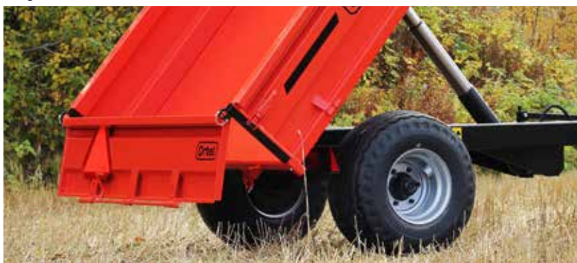
Topp- og bunnhengsla strøluke i 3mm stål
