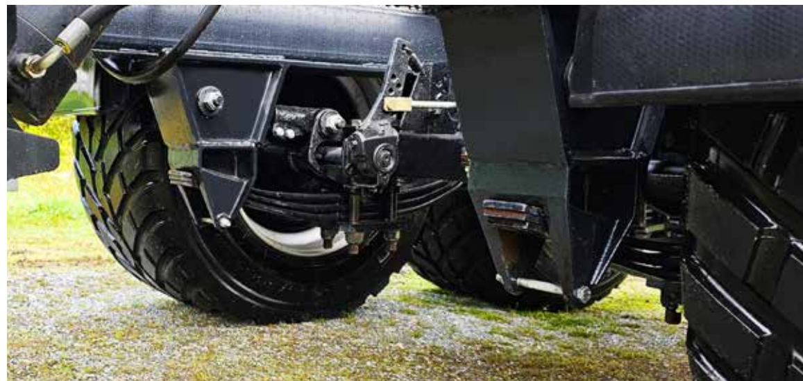
Fjærede akslinger med 10 bolters nav.
