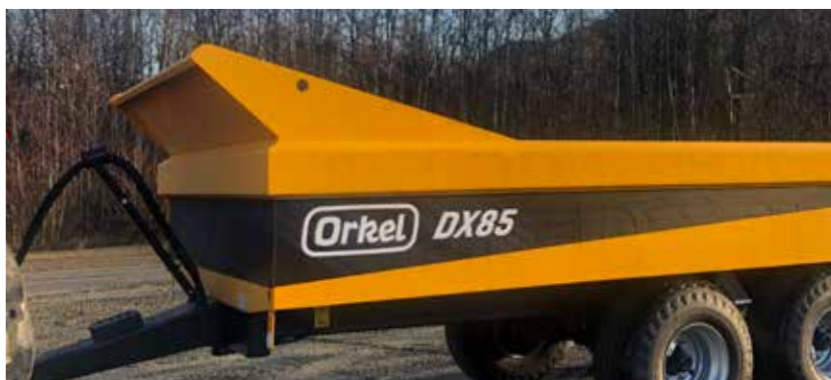
Solid frontskjerm til framkarm
