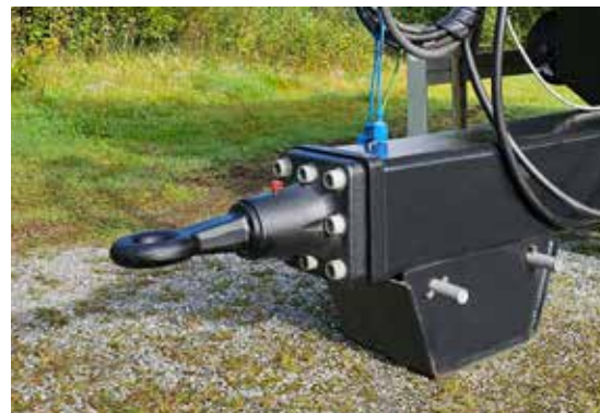
Trekkøye kan byttes til K80 kulekabling
