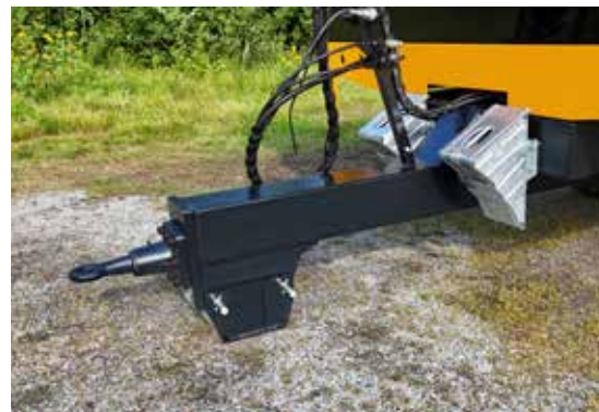
Vridbart trekkøye kan byttes til K80 kulekobling
