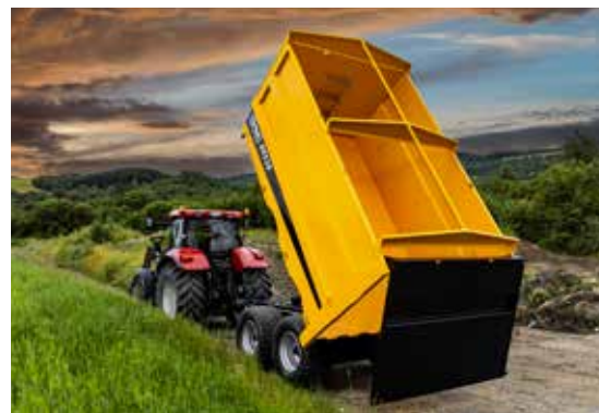
Tippvinkel på opptil 58° med både standardkarm og høgkarm
