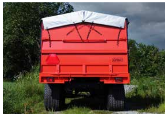
Topp- og bunnhengsla strøluke i 3mm stål
