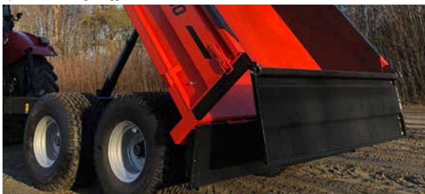
Toppengslet strøluke i 2 mm stål
