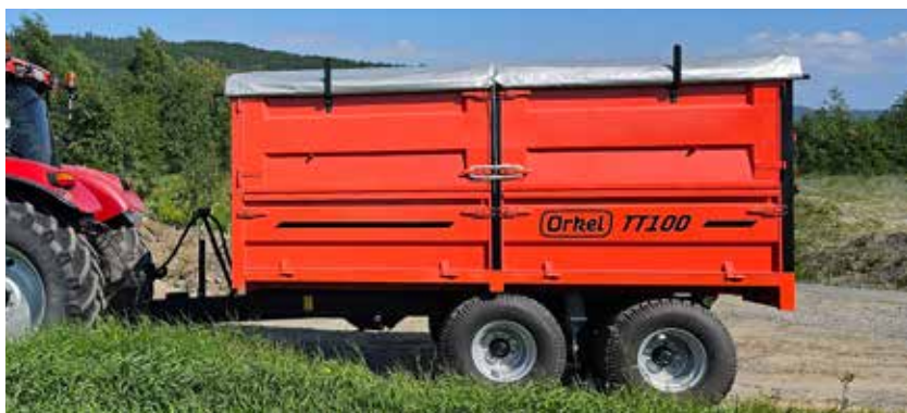
Delte høgkarmer med sidehengsling
