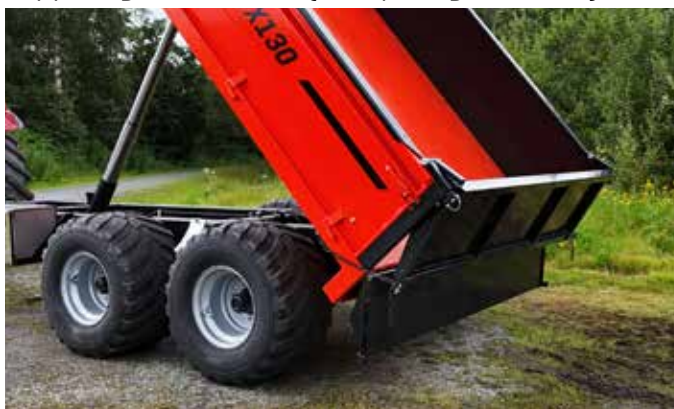
Topphengslet strøluke [Dumper og landbruk]
