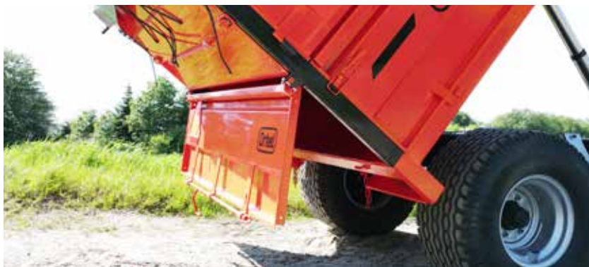
Topp- og bunnhengsla strøluke i 3mm stål og delte sidekarmer med hengsling
