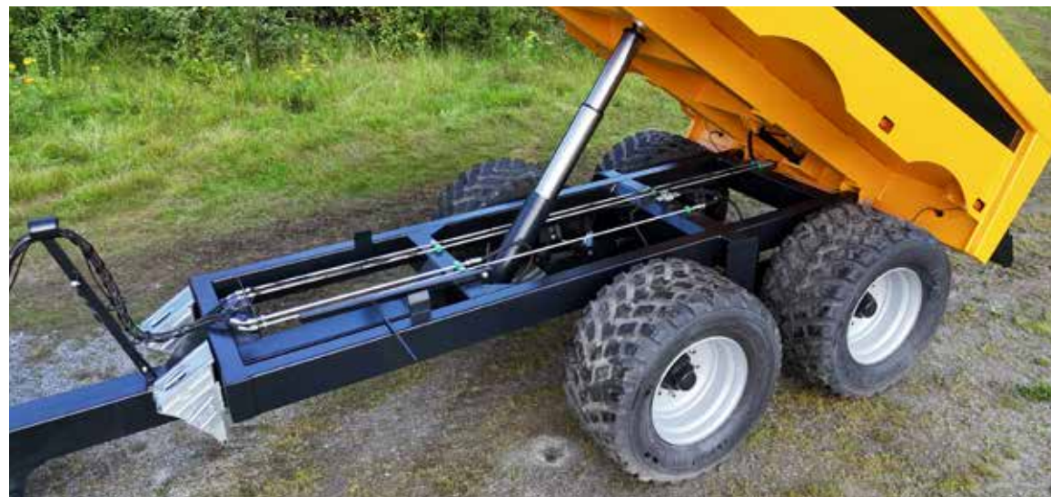
Rørkoblinger for enkelt bytte om det skulle oppstå skader
