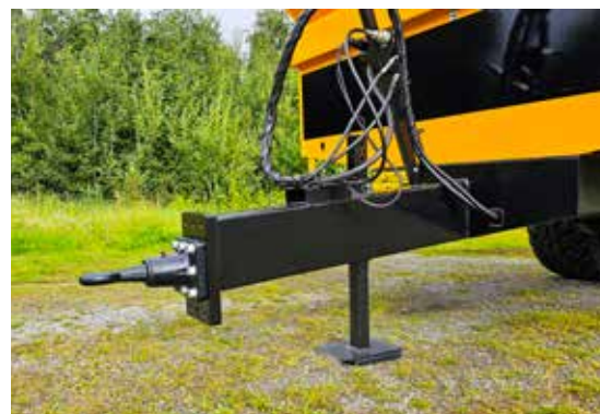
Vridbart trekkøye kan byttes til K80 kulekobling
