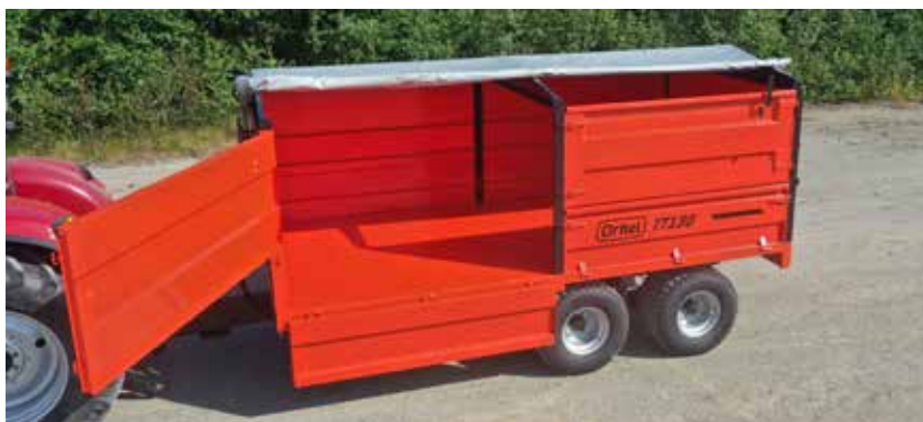
Delte høgkarmer med sidehengsling og rullbar presenning med møne
