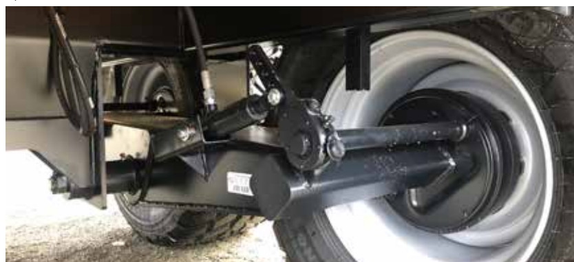
Solide boggikasser med forsterkede nav og utvendige bremsesyndere.
