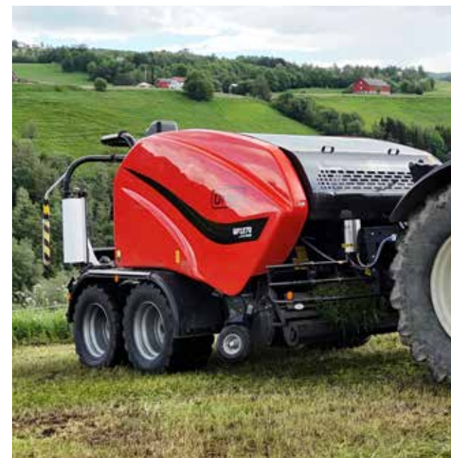
Store sidedeksel gir suveren adgang til daglig vedlikehold og rengjøring. Plastmagasin med nedfellbare plastholdere som rommer inntil 10 stk 750 mm plastruller.
