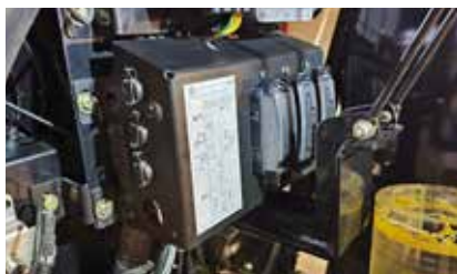
Sikringer og strømutgang for tilleggsutstyr f.eks lys og syreutstyr
