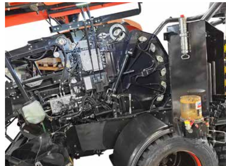
Sideåpning som gir suveren adgang til daglig vedlikehold og rengjøring
