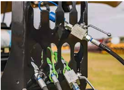
Stor slangeholder gjør det enkelt å ha kontroll på hydraulikkslanger og tilkoblinger for strøm og eventuelt syretilførsel
