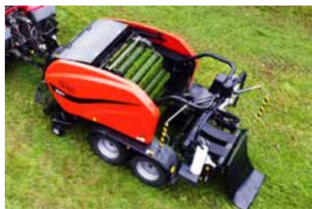
Store sidedeksel gir suveren adgang til daglig vedlikehold og rengjøring. Plastmagasin med nedfellbare plastholdere som rommer inntil 10 stk 750 mm plastruller.
