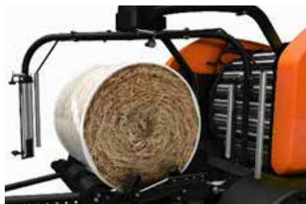
GP 1270 Kombi strekker bredplaten over kanten på ballen
