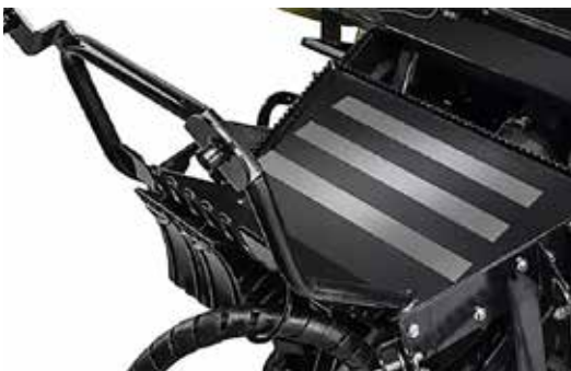
Plattformen lar deg stå stødig under skifte av nettrull.
