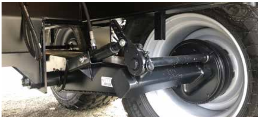
Solide boggikasser med forsterkede nav og utvendige bremsesyndre.
