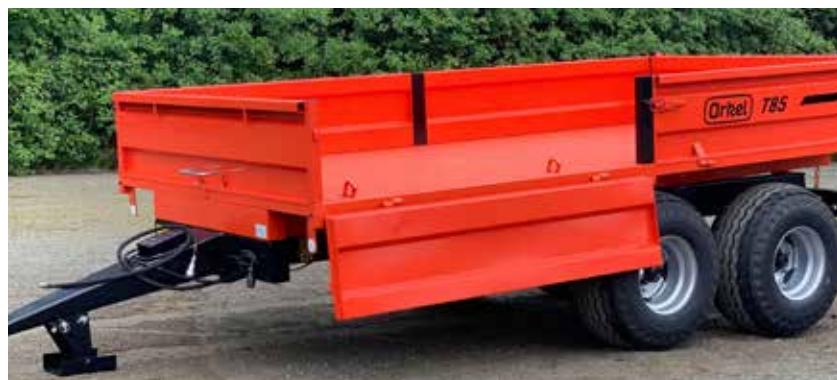
Delte sidekarmar med hengsling
