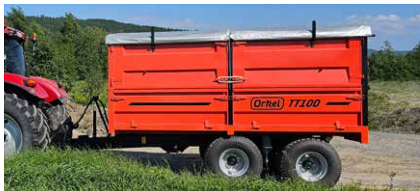
Delte høgkarmer med sidehengsling
