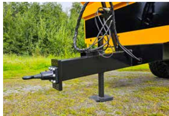
Vridbart trekkøye kan byttes til K80 kulekobling
