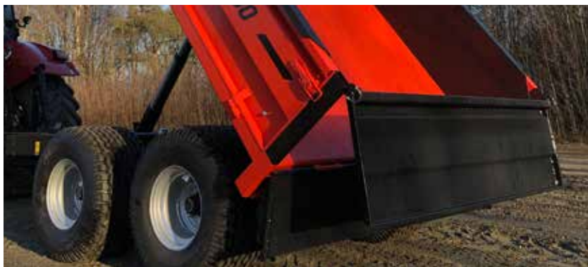
Topphengslet strøluke i 2 mm stål
